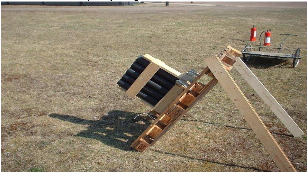
Vi skjuter D – Max skjutning för att studera maximal räckvidd på bomber .
